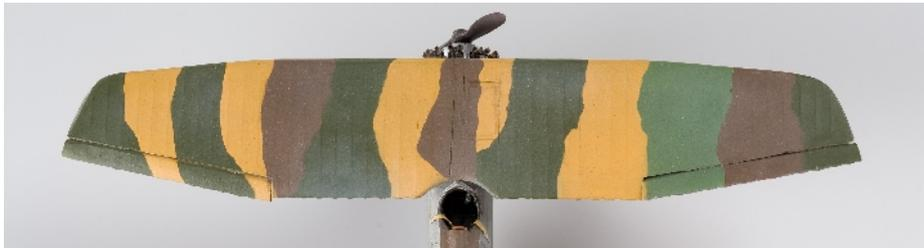
Per riprodurre la centinatura leggermente sporgente attraverso il rivestimento in tela, il dorso e il ventre dell’ala sono stati rivestiti con un sottilissimo foglio di plasticard (fondo di un piatto per uso alimentare) su cui al rovescio con una matita dura è stata tracciata la centinatura stessa.
